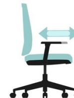
La almohadilla del reposabrazos se desliza hacia adelante y hacia atrás.
