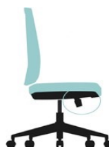
Ajuste de la tensión de inclinación
